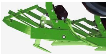
Nach dem Motto „Flach pflügen und tief lockern“ erreicht man mit den Untergrunddornen eine Lockerung der Bodenschichten unter der Pflug-Arbeitstiefe. Die Lockerungsdorne sind in der Höhe verstellbar und für geringe Verschleißkosten einfach austauschbar ausgeführt.
