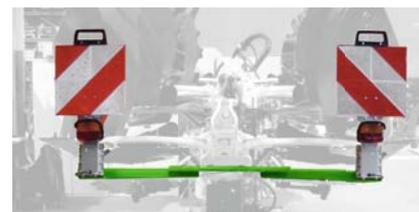
Alle Cayros-Pflüge sind für den Straßenverkehr auch mit einer Beleuchtungsanlage auszurüsten. Wahlweise linksabweisend (für Transportfahrt mit Pflug in Arbeitsstellung) oder auch doppelseitig bei Verwendung eines Transport-Stützrads sorgen diese Beleuchtungen so für Sicherheit im Straßenverkehr.
