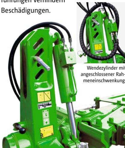
Wendezylinder mit angeschlossener Rahmeneinschwenkung.
