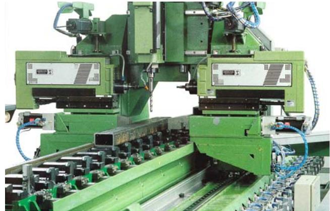
Alle Rahmenrohre werden auf einer speziell entwickelten Bohranlage verbohrt, alle Bohrungen werden mit einer einzigen Aufspannung gefertigt, was absolute Präzision beim fertigen Gerät garantiert.
