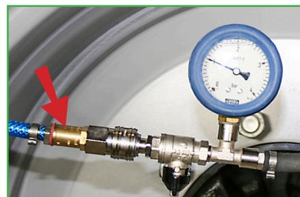
Der Füllschlauch wird in den Kupplungskopf eingesteckt, kann aber auch an jeden Werkstattkompressor angekuppelt werden.
