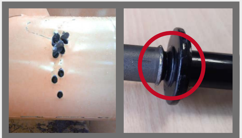
Schäden an der Schnecke, die durch falsches Brechen eines Fingers verursacht wurden.
